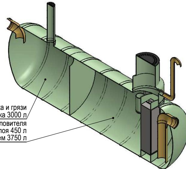
Камера для улавливания песка и грязи
